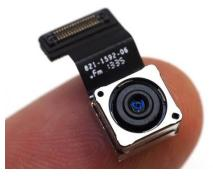
+ Cheaper, power efficient- Noisier, rolling shutter readout
